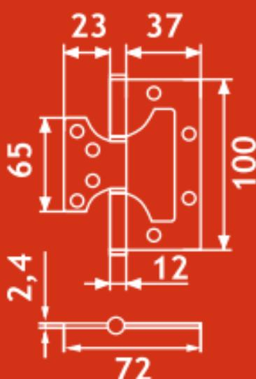
**Назначение** — для крепления деревянных межкомнатных дверей, левого и правого открывания.
